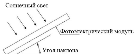
Рис. 1 Схематическое изображение угла наклона
