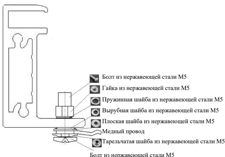
Рис. 15 Заземление алюминиевого корпуса с медным проводом
